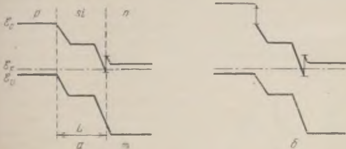
Рис. 117. Зонные энергетические диаграммы гетероструктур на основе полужизолирующего GaAs:
