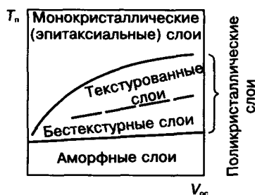
Рис. 22.1. Влияние кинетических условий получения на структурное состояние слоев и пленок. V_{\infty} — скорость осаждения
