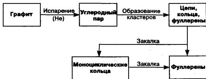
Рис. 3.23. Схема получения фуллеренов
