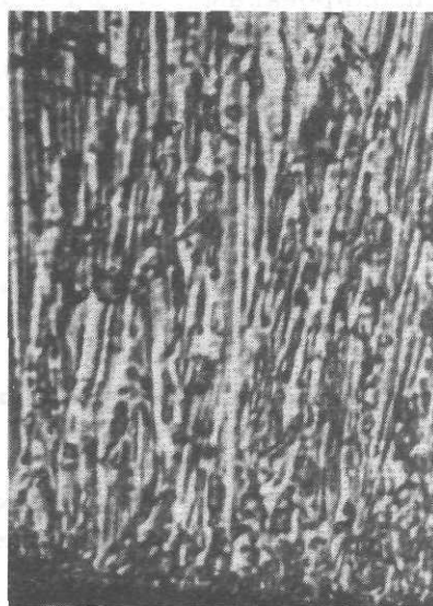
Рис. 22.4. Столбчатая форма зерен текстурованных поликристаллических пленок кремния
