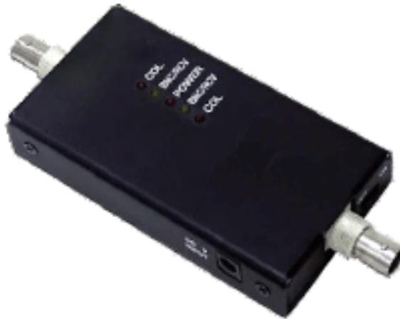
Устройство для увеличения расстояния сетевого соединения путём регенерации электрического сигнала «один в один».
